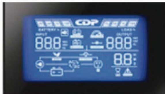
Muestra voltajes de entrada, salida, tiempos de autonomía y carga de batería
